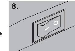
关闭电源开关,切断电源。
