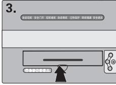
向前推进纸口处的透明盖,使其翻转进入碎纸机机体内,露出碎纸机进纸口。
