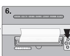
当你想中止正在粉碎的纸张时,请按下“R”键,机器将会立即反转将待碎纸张退出,重新回到待机状态
