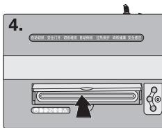
用手试着接近碎纸机纸张进口处,验证安全触摸功能是否启动。
