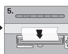
确保触摸感应功能正常的状态下,把待碎纸放入进纸口,机器自动启动碎纸。
